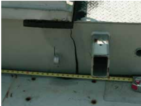
Ресурсные испытания позволяют выявить возможные дефекты конструкции, которые не всегда обнаруживаются в ходе анализа методом конечных элементов.
